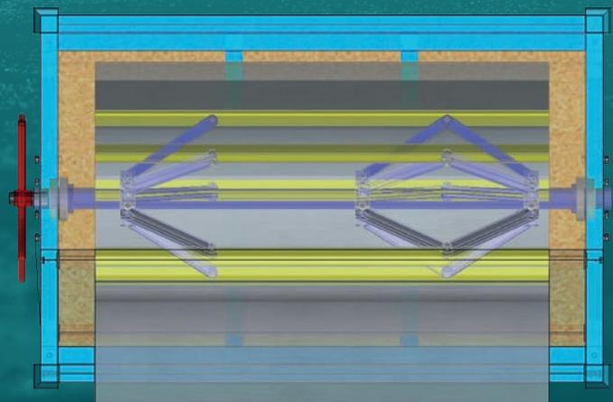
Unser stapelbarer Coilträger bietet eine platzsparende und sichere Lagermöglichkeit für Coils. Dank des patentierten Systems bleibt der Coil aufgewickelt und verhindert so unerwünschtes Abwickeln.
